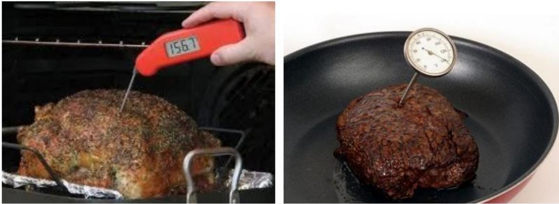
شكل (6-6) يبين المحرار المستكشف Probe thermometer أو المسبار الحراري.
