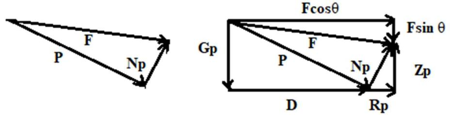
يظهر من مخطط القوى بالشكل السابق ان مقاومة التربة  $D$  ووزن الآلة  $Gp$  يشكلان المحصلة  $P$
